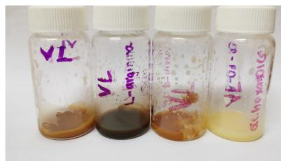
Figura 2. Oligómeros derivados de la PVL obtenidos después de 48 horas de reacción a  $150^\circ C$ . De izquierda a derecha: ciprofloxacino, L-arginina, ácido p-nitrobenzoico y ácido hexanoico.
