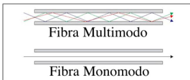
Figura 1.4: Fibras multimodo y monomodo; según su tipo, son capaces de guiar uno o más modos diferentes de ondas. Recuperado de <https://telpromadrid.eu/que-es-la-fibra-optica-monomodo-y-multimodo/>. Accedió el día 18/07/2022
