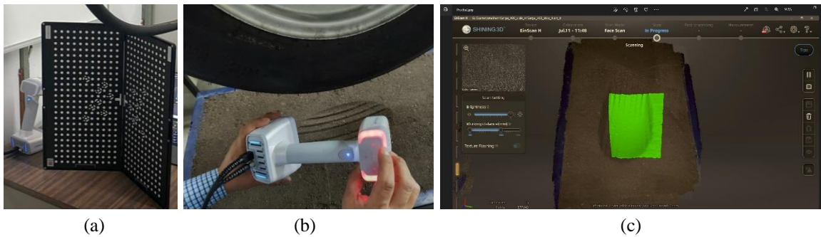
Figura 3. (a) Calibración del escáner, (b) escaneo de huella y (c) digitalización de la huella.
