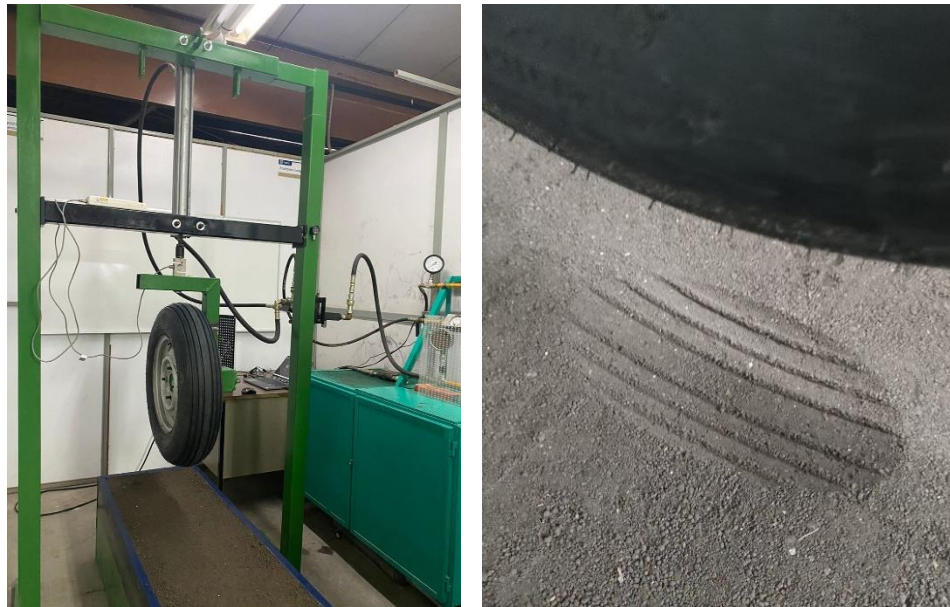
Figura 2. Prototipo de banco hidráulico para pruebas experimentales de compactación de suelo agrícola.
