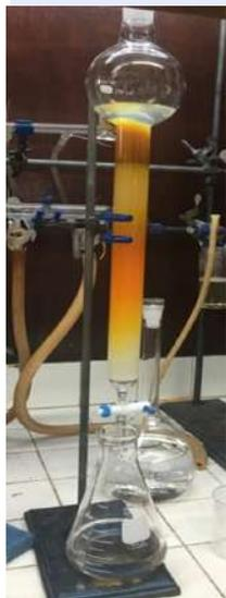
Para separar al ligante azufrado SacNac, de los demás subproductos, utilizamos la cromatografía en columna, la cual se muestra a la izquierda.
