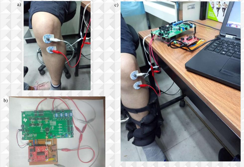
**Figura 1.** Montaje del sistema experimental a) Colocación de electrodos a lo largo del tendón rotuliano b) Sistema EBMS-DIF-DCI-UG c) Montaje del experimento rodilla-equipos de impedancia.
